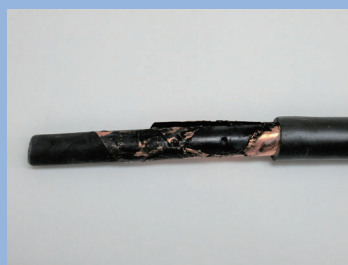
ケーブル事故写真
