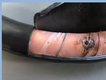
人工地絡試験によるケーブル事故写真
