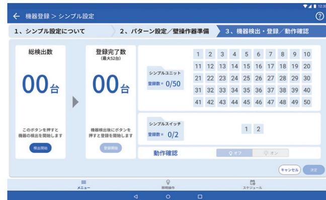
シンプル設定は、照明器具のON/OFFと調光パターン操作を壁操作器だけで操作したい場合に、登録と設定を同時に行います。各機器の設定を省略できる便利な時間短縮機能です。
