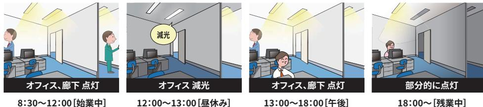
※5 計算条件：(一社)日本照明工業会発行 照明器具リニューアルのすすめ(照明器具カエルBOOK2023) P.6より引用8~9時、19~22時：50%点灯、12~13時：25%減光、9~12時、13~19時：100%点灯のスケジュール制御時の一例
