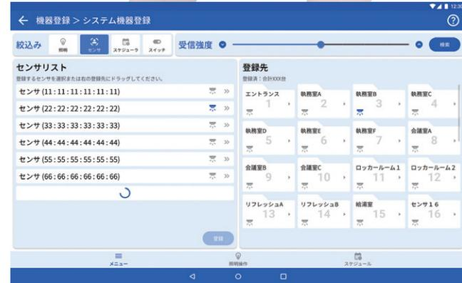
システム機器登録は、照明・センサー・スケジューラー・スイッチの各機器をタブレット画面操作により登録します。受信範囲内にある未登録機器がリストアップされ各機器の設定を行います。
