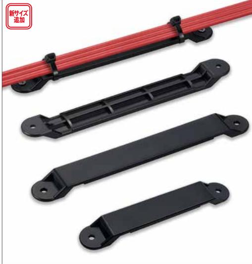
溶接作業なしに、簡単に取り付けられる配線固定具です。プラスチック製のため軽量で、金属製電線支え具のように電線被覆を傷つける心配がありません。電線にゴムなどの緩衝材やビニールテープを巻く必要がなく、作業性向上・部品点数削減に貢献します。また、細い電線束でも結束バンドで締め付けることで電線のスレを 방지、分岐も容易です。
